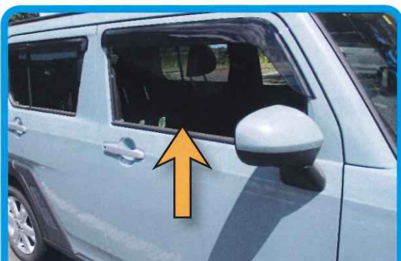
駐車中の車 草刈中の飛び石(サイドガラス破損)
